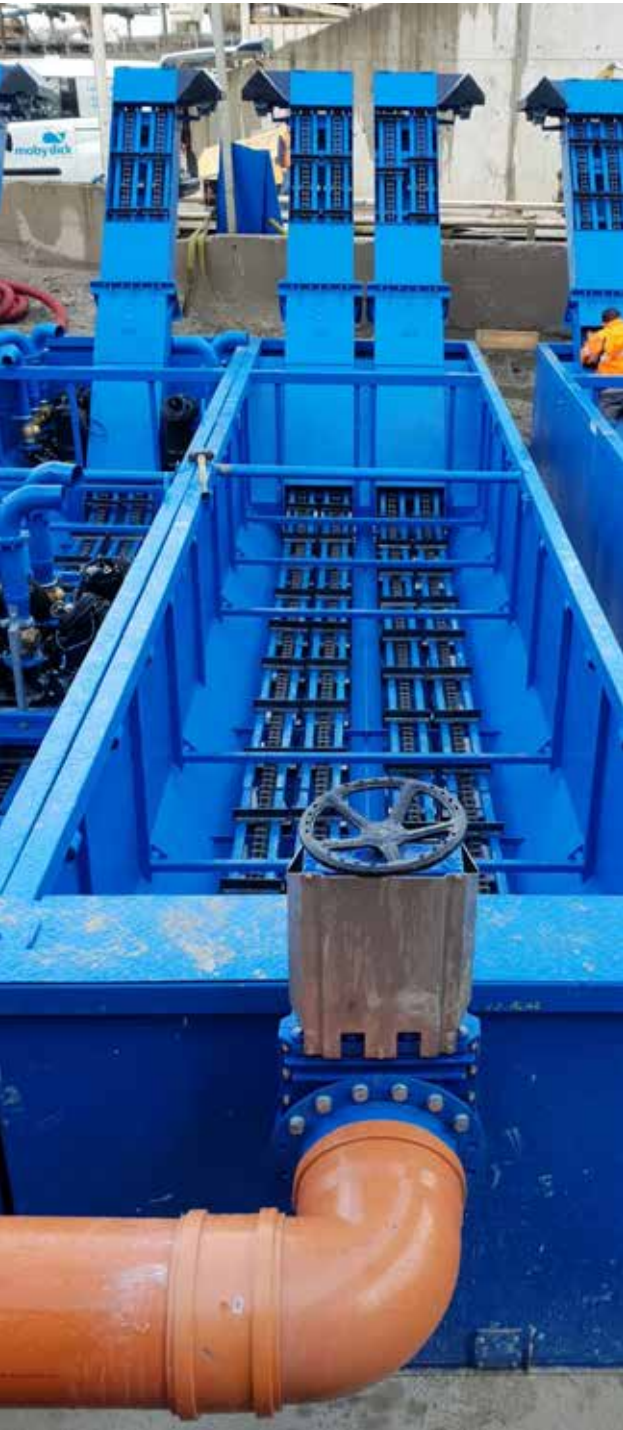
Recycling tank 50DCC double scraper conveyor technology Tanque de reciclaje 50DCC con tecnología de doble transportador rascador
