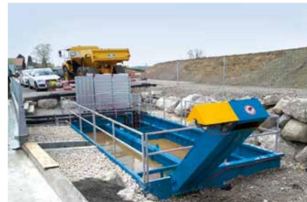
Recyclingtank 50 mit Kratzförderer und Recyclingtank 50
