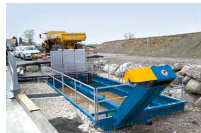
Recyklační nádrž 50 se škrabákovým dopravníkem a recyklační nádrží 50 Zbiornik recyklingowy 50 z przenośnikiem zgrzeblowym i zbiornikiem recyklingu 50
