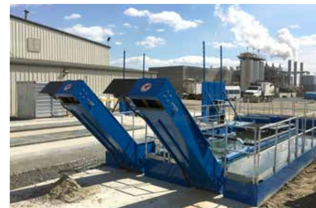
2 x Recyklační nádrž 50 se škrabákovým dopravníkem 2 x Zbiornik recyklingowy 50 z przenośnikiem zgrzeblowym
