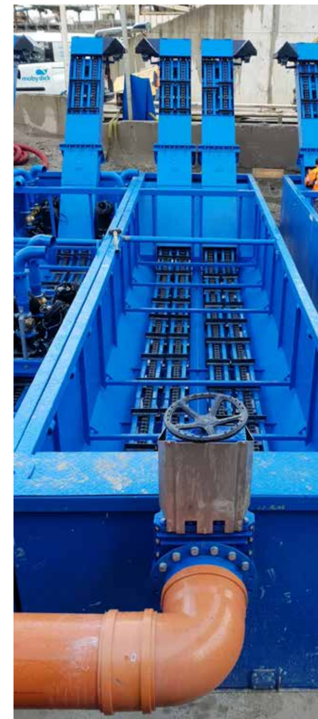
Recyklační nádrž 50DCC Technologie dvojitého škrabákového dopravníku Zbiornik recyklingowy 50DCC - technologia podwójnego przenośnika zgarniającego
