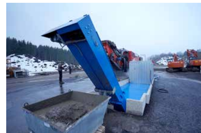
Recyklační nádrž 50 se škrabákovým dopravníkem Zbiornik recyklingowy 50 z przenośnikiem zgrzeblowym
