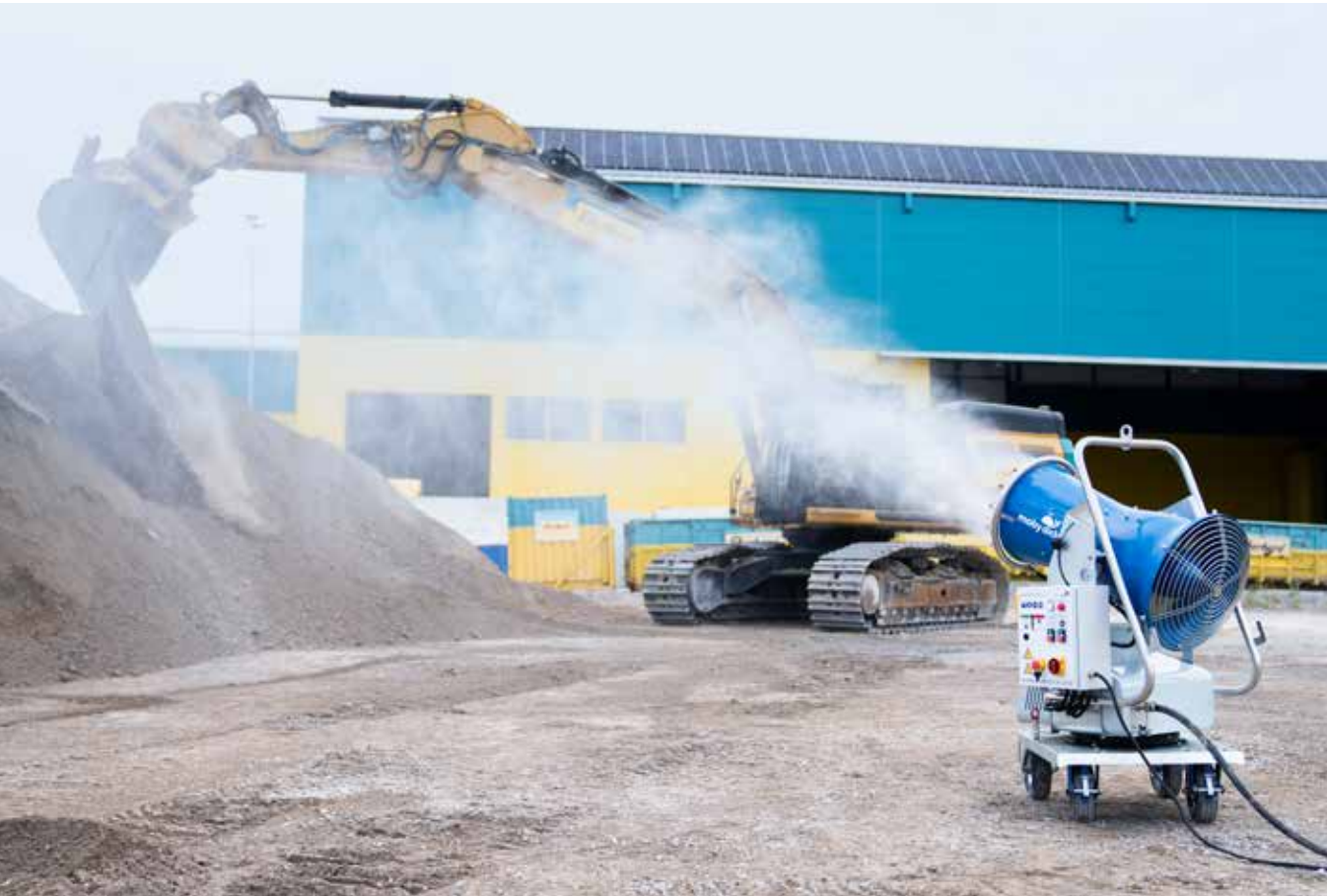
Cannon Cart – La plus petite MobyDick en action Cannon Cart – Il MobyDick più piccolo in uso
