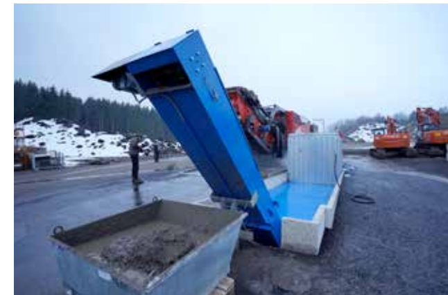
Réservoir de recyclage 50 avec évacuateur à racleur Serbatoio di recupero 50 con nastro trasportatore a raschiamento
