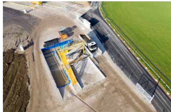
Réservoir de chargeuse sur pneus 85 avec réservoir de recyclage 50 Serbatoio per pala caricatrice 85 con serbatoio di recupero 50
