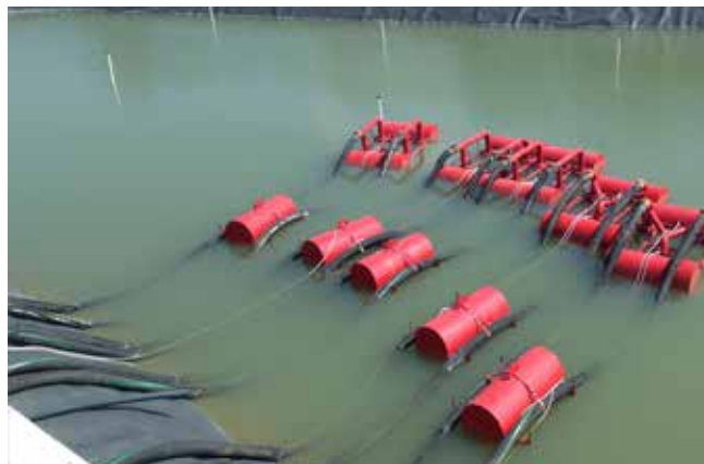
Bassin avec pompes MobyDick et pontons Vasche con pompe e pontoni MobyDick
