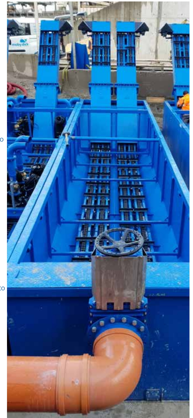
Réservoir de recyclage 50DCC Double technologie de transporteur à raclettes Serbatoio di recupero 50DCC tecnologia nastro trasportatore a raschiamento
