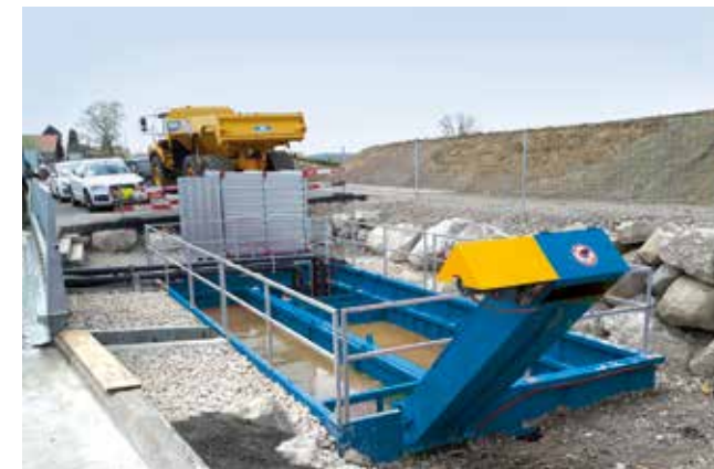
Réservoir de recyclage 50 avec convoyeur à raclette avec réservoir de recyclage 50 Serbatoio di recupero 50 con nastro trasportatore a raschiamento con serbatoio di recupero 50
