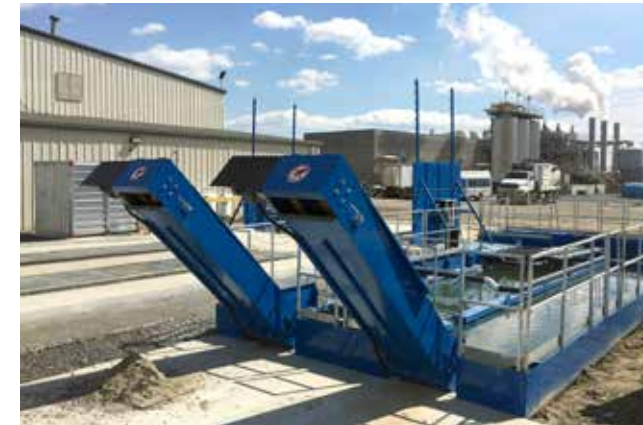
2 x Recyclingtank 50 mit Kratzförderer 2 x Recycling tank 50 with scraper conveyor
