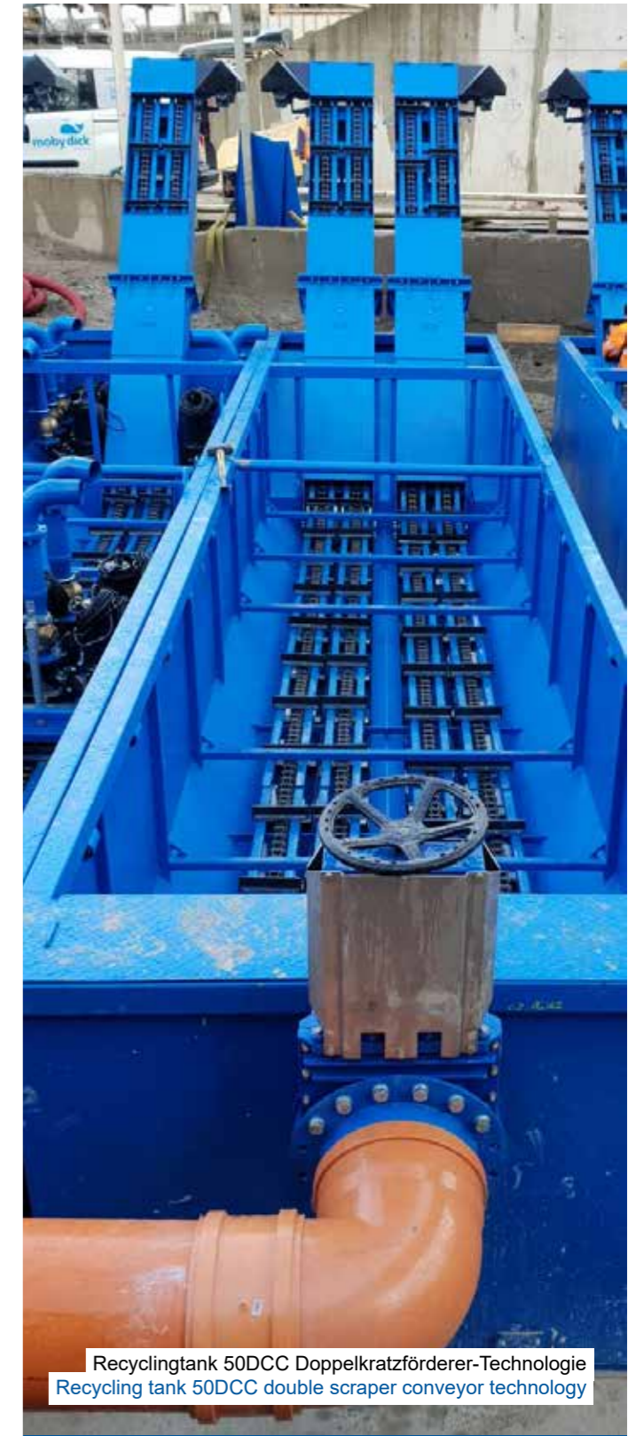
Recyclingtank 50 mit Kratzförderer Recycling tank 50 with scraper conveyor
