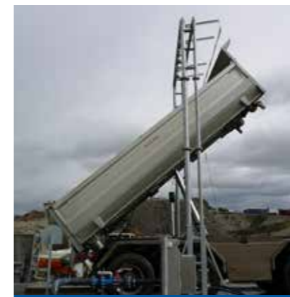
Automatische Brückenwäsche Automatic load area washing
