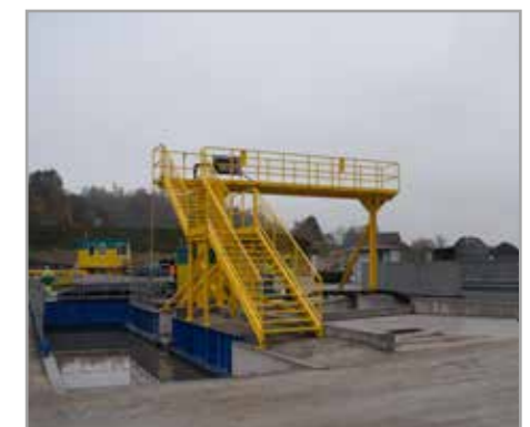
Truckbed wash in combination with a wheel washing system Lavado de puente en combinación con un sistema de lavado de neumáticos
